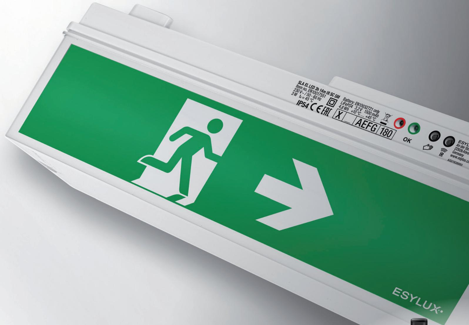
As luminárias de emergência com acumulador da série SLA são uma solução clássica para a identificação de saídas de emergência nas quais é exigida uma distância de reconhecimento de 14 metros. O fácil teste de funcionamento é realizado através do botão de teste ou do controlo remoto; em alternativa, está disponível uma variante com automonitorização. Uma vasta gama de acessórios permite a utilização e uma montagem fácil em todos os ambientes comuns.
