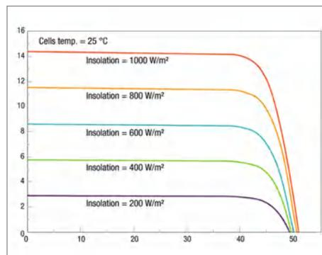
Curva corrente-tensão do módulo M580N72LM-SF-F3 4099854173370
